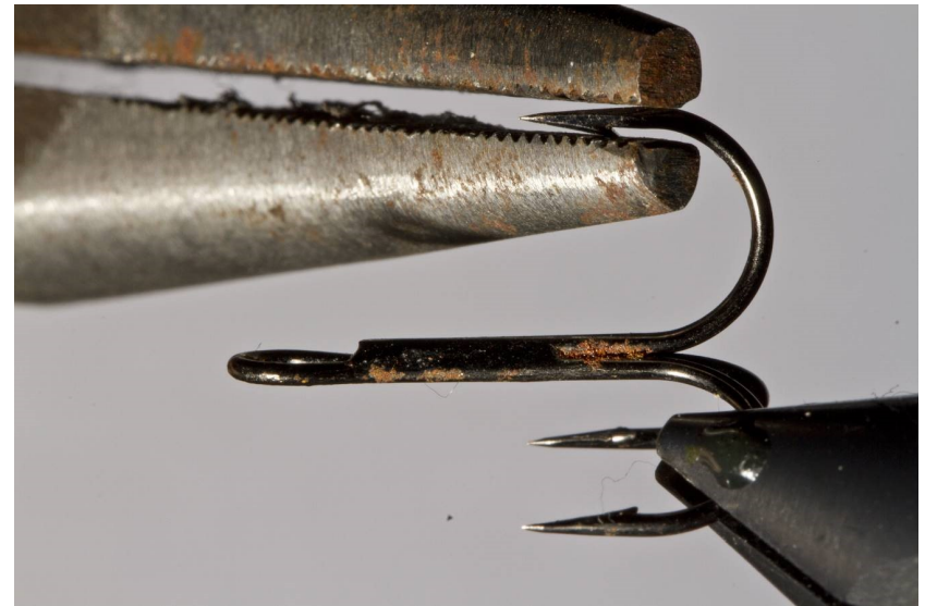
Benyt en spidstang til at klemme alle modhager ned. Nogle kroge at hårdere i godset, og her kan det være nødvendigt at bruge en papegøjetang/polygriptang for at få modhagen ordentligt ned.
