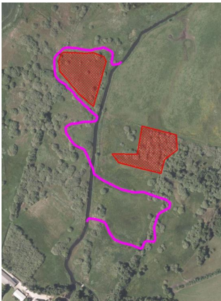
Tegning: Trend Ås nye slyngede forløb opstrøms dambruget (lyserød streg). Opstuvningszonen fjernes helt ved at stemmeværket nedbrydes. De røde områder er særligt værdifuld mose.
